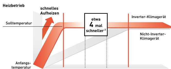
2) Vergleich von je einem Inverter- und Nicht-Inverter-Gerät mit 2,5 kW. Außentemperatur: 2 °C; Solltemperatur: 25 °C
