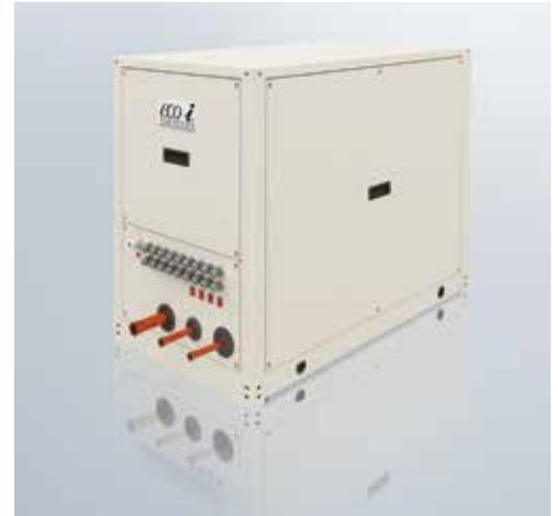
Die Kältemittel-Sammelstation von Panasonic ist schnell und einfach zu installieren. Das in Schutzart IP54 ausgelegte Gehäuse der Sammelstation enthält 5 Kugelventile mit Stelglied, einen 30-l-Kältemittelsammler und die zugehörige Steuerung. Die Klemmen für den Störmelde-Ausgang, die Hochdruck- und Niederdruck-Meswertgeber und die Heißgastemperaturfühler der Außengeräte befinden sich an der Frontseite der Sammelstation, um das Anschließen zu erleichtern.
