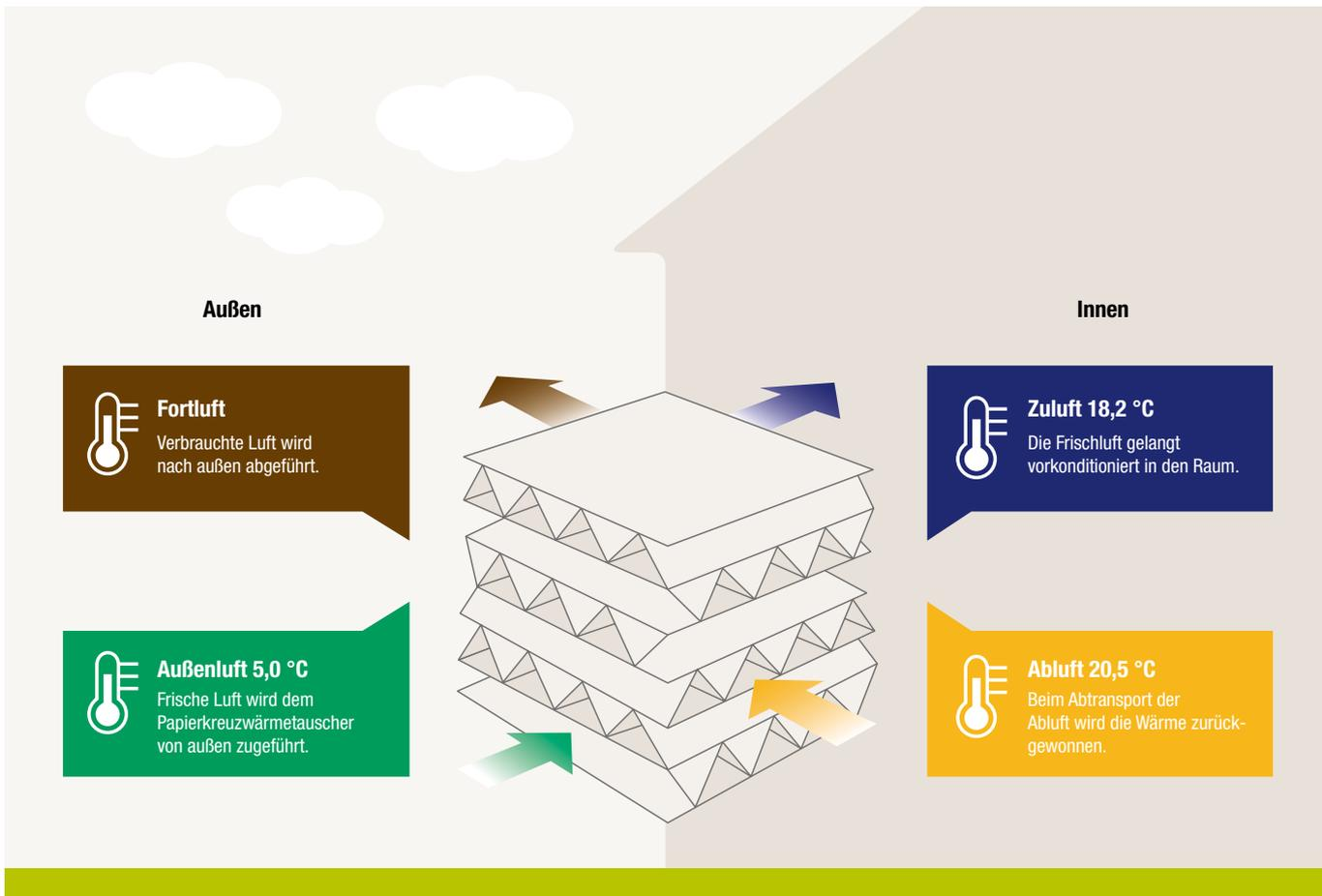
Struktur und Funktion des Papierkreuzwärmetauschers, Berechnungsbeispiel mit VL-50(E)S2-E bei niedriger Lüfterstufe in 230 V/50 Hz:  $18,2\text{ °C} = (20,5\text{ °C} - 5\text{ °C}) \times 85\% + 5\text{ °C}$
