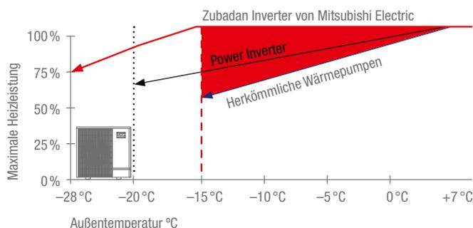
Mit zuverlässigem Wärmepumpenbetrieb selbst bei  $-28^{\circ}\text{C}$  und voller Heizleistung bis  $-15^{\circ}\text{C}$  verfügt die patentierte Zubadan Inverter-Technologie über ein deutlich größeres Leistungspotenzial als herkömmliche Systeme.
