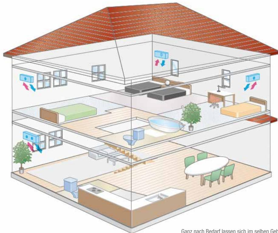
Ganz nach Bedarf lassen sich im selben Gebäude die Lüftungsgeräte VL-50 und VL-100 kombinieren.
