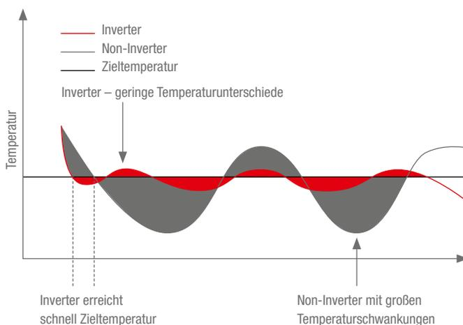
Inverter-Technologie sorgt für schnelles und zielgenaues Erreichen der gewünschten Temperatur. So werden aufwändiges Nachregeln, große Temperaturschwankungen und der damit verbundene Effizienzverlust zuverlässig minimiert.
