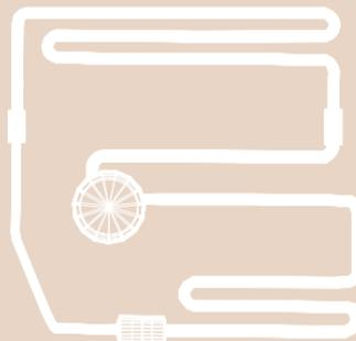
Innerhalb des Kältekreislaufes transportiert das Kältemittel die entzogene Wärme vom Innen- zum Außengerät und kühlt sich über den Wärmetauscher wieder ab. Es fließt im flüssigen Zustand zurück zum Innengerät um erneut Wärme aufzunehmen und in den gasförmigen Zustand zu gelangen. Im Heizbetrieb kehrt sich diese Funktion um: Das Kältemittel entzieht der Außenluft Wärme und transportiert diese in den Raum.
